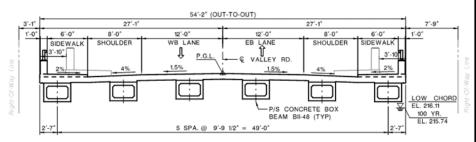
TYPICAL SECTION - CONCRETE SPREAD BOX BEAM ALTERNATIVE (LOOKING EAST)
