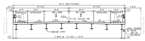
TYPICAL SECTION - STEEL ROLLED BEAM ALTERNATIVE
