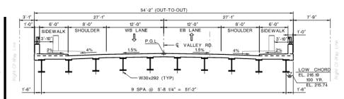
TYPICAL SECTION - STEEL ROLLED BEAM ALTERNATIVE
