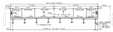
TYPICAL SECTION - STEEL ROLLED BEAM ALTERNATIVE
