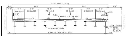
TYPICAL SECTION - STEEL ROLLED BEAM ALTERNATIVE
